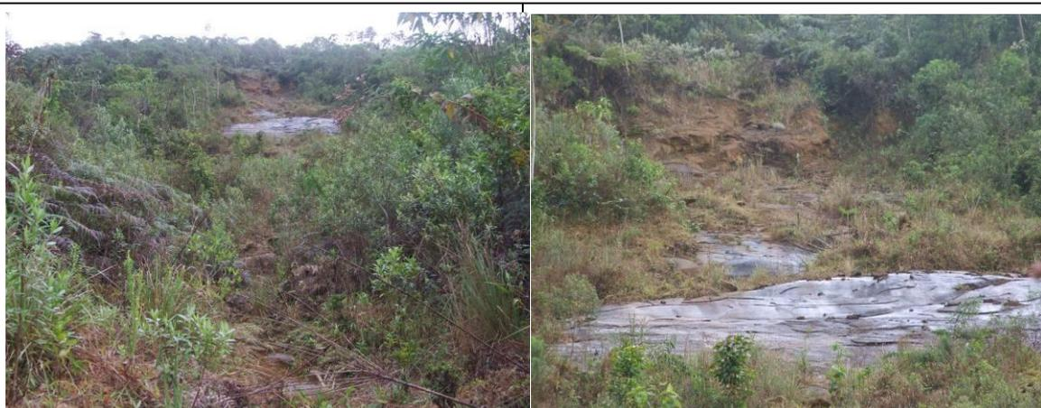
Foto 83 e 84 – Escorregamento planar com superfície de ruptura solo rocha que ocorre nas encostas íngremes do relevo de Montanhas e Morros que constituem os Terrenos Montanhosos e Escarpados.214 / 215 (23 K 566501 7477469)
