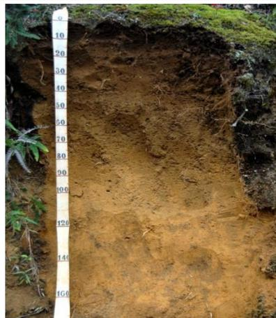
Fotos 103 e 104 – Solos característicos dos Terrenos Amorreados: Argissolo Amarelo distrófico textura arenosa/média e média/argilosa (PA=23 K 555665 7475316); Cambissolo Háptico Tb distrófico textura média (CX=23K 555938 7476005); relevo de Morros e Morrotes Paralelos e caracteriza os Terrenos Amorreados.
