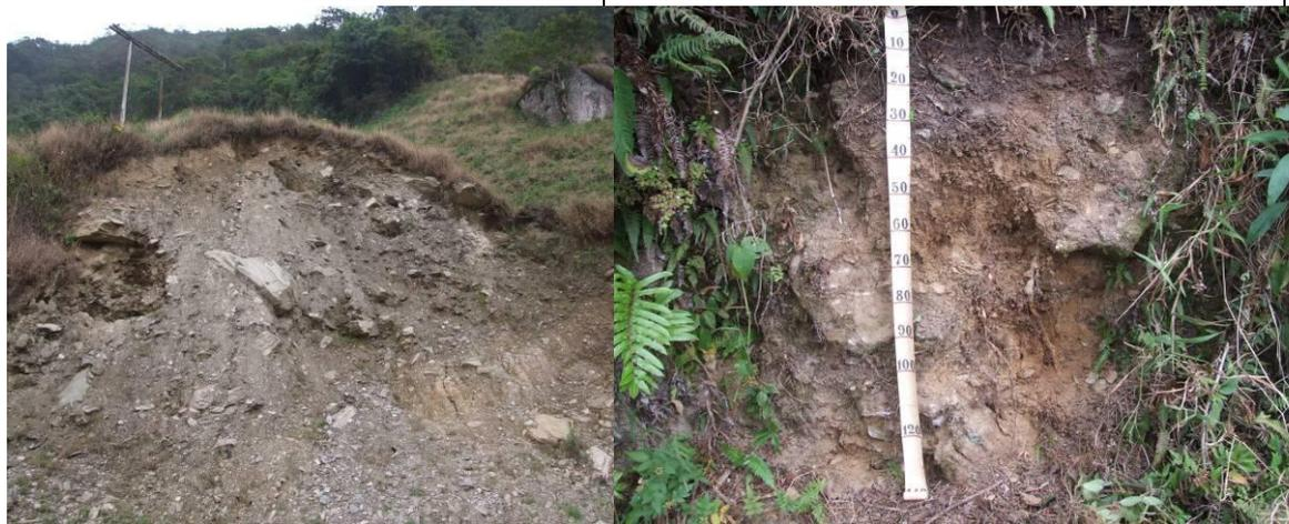
Fotos 47 e 48 – Blocos e matações anguloso em matriz argilo-arenosa rica em fragmentos de muscovita leucogranito fortemente foliado, que constituem Corpo de Tálus gerados por processos erosivos gravitacionais e pluviais do tipo movimentos de massa, em que se destacam os escorregamentos e as quedas de bloco. Esses depósitos associam-se a Cambissolo Háptico Tb pedregosos ou não e rochosos ou não distróficos textura média e argilosa.153 / 156
