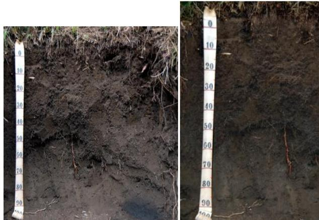
Fotos 113 e 114 – Solos que ocorrem esporadicamente nos sopés de vertente ou zonas abaciadas dos Terrenos Amorreados Baixos: Organossolo Háplico Sáprico ou Hêmico térrico (O=23K 556668 7477114)
