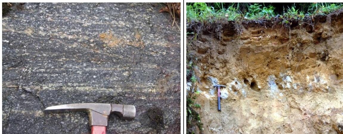
Fotos 71 e 72 – Termo mesocráticos, de granulometria média que caracteriza o hornblenda-biotita gnaíse migmatítico do Complexo Quirino, que origina solo de alteração areno-siltoso a argilo-siltoso por vezes micáceos e rico em grânulos de quartzo e feldspato, sendo comum à presença de blocos e matacões imersos. O solo superficial é argiloso a argilo-arenoso, Cambissolo Háplico Tb textura argilosa e média pedregoso e rochoso. 105/107 (23 K 563730 7479200)
