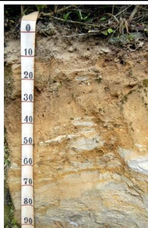
Fotos 87 e 88 – Solos característicos dos Terrenos Montanhosos e Escarpados: Cambissolos Hápicos Tb/Ta eutrófico e distrófico textura média e argilosa pedregosos ou não e rochosos ou não (CX=23K 564048 7480743 e 23K 556719 7479907);
