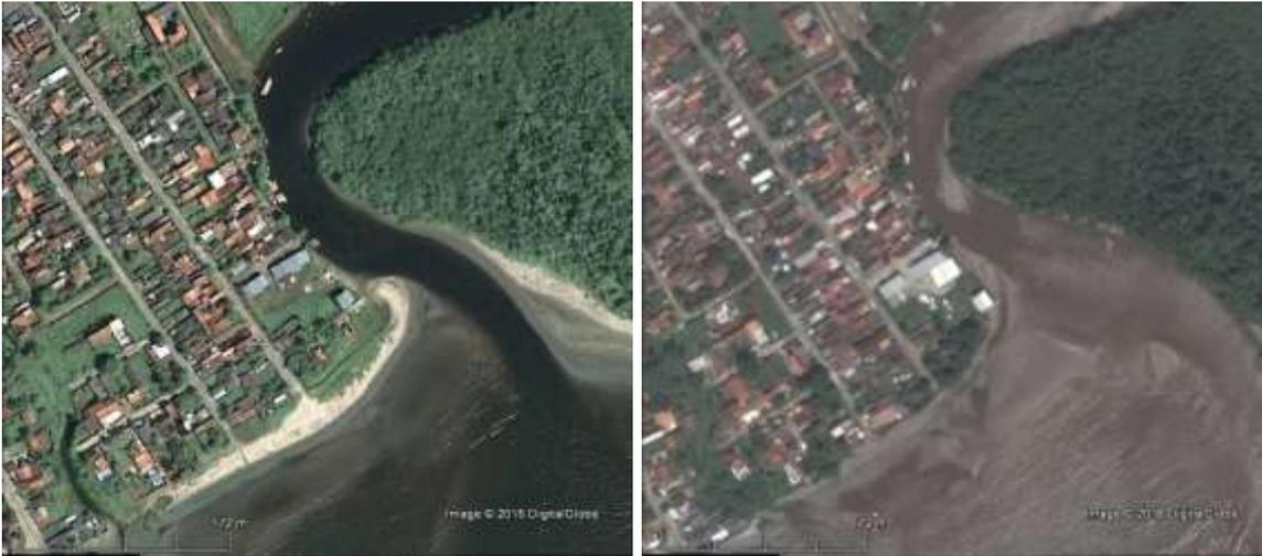
Figura 3.1.2.1.1-42 – Erosão da margem direita do Rio Juqueriquerê – imagem da esquerda em 03.04.2009 e da direita em 17.02.2016. Fonte: Google Earth PRO.
