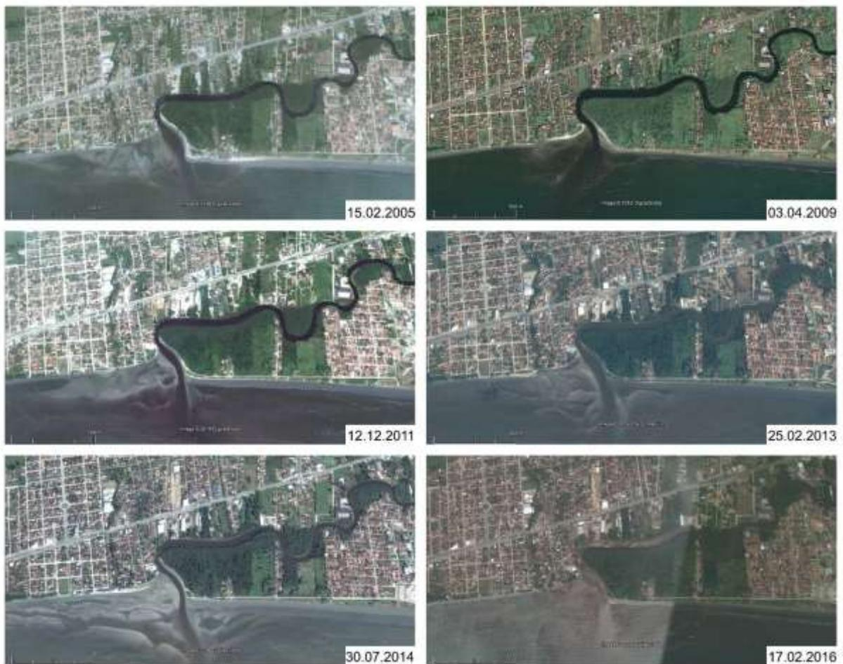
**Figura 3.1.2.1.1-44 –** Imagens de satélite do Rio Juqueriquerê onde é possível se observar a deposição de sedimentos na região adjacente costeira. As datas e a origem da imagem estão apresentadas em cada painel.
