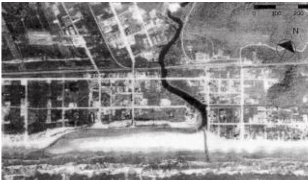
Figura 3.1.2.1.1-26 – Vale do rio Mongaguá em 1997 (escala 1:10.000 – *apud* Tessler *et al.*, 2006) totalmente urbanizado com o rio canalizado. A desembocadura é marcada por um molhe fixo, que não permite mais a migração desta.
